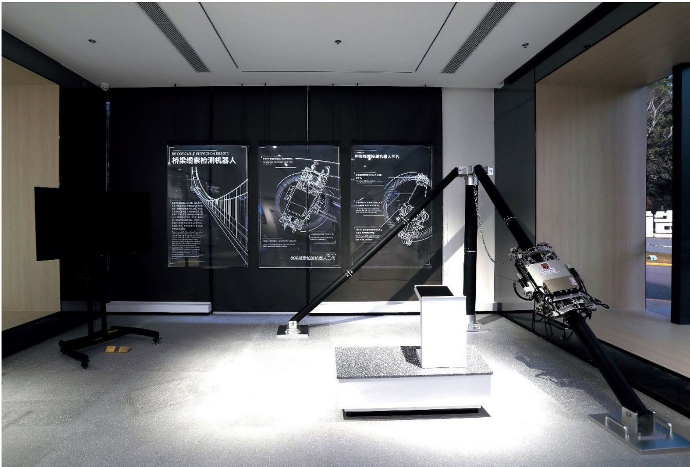
深圳市人工智能和机器人研究院研发的桥梁缆索检测机器人
